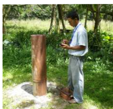
Lettura dati idrometrici tramite palmare HDA
