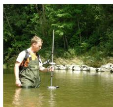
Misura della portata con AquaProfiler™-M-Pro
