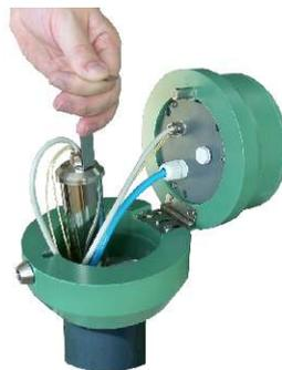
Facile sostituzione delle batterie dal sistema "LogCom"
