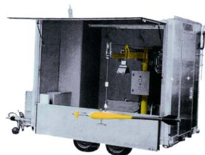
Carrello di misura con arganello SEW - II in versione meccanica o elettrica per misure di portata da ponti
