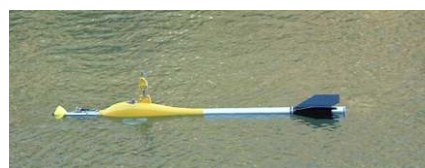
Esecuzione delle misure con mulinello SEBA F1
